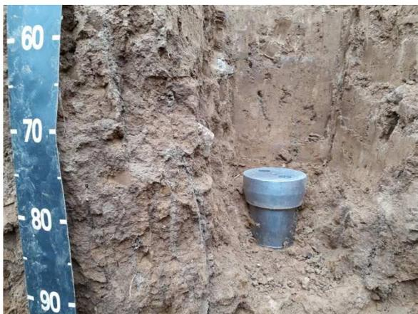
Figure 10 : Prélèvement en vue d'une mesure de densité apparente de sol non à peu caillouteux à l'aide d'un cylindre de 500 cc
